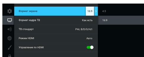
**Режим HDMI** — выбор разрешения, в котором будет выводиться видеоизображение при подключении приемника к телевизору с помощью HDMI-кабеля.
